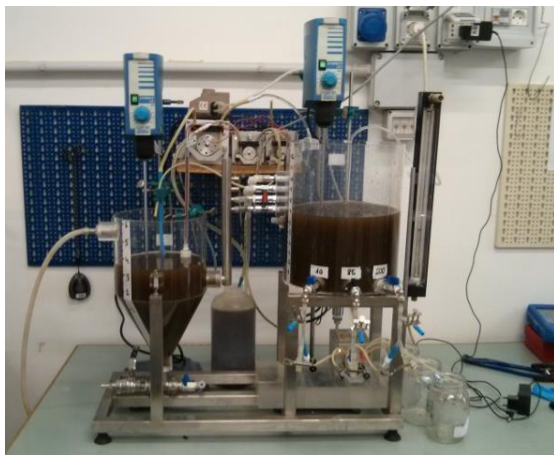
Sperimentazione processo DyMANOx per rimozione N da percolato di discarica
