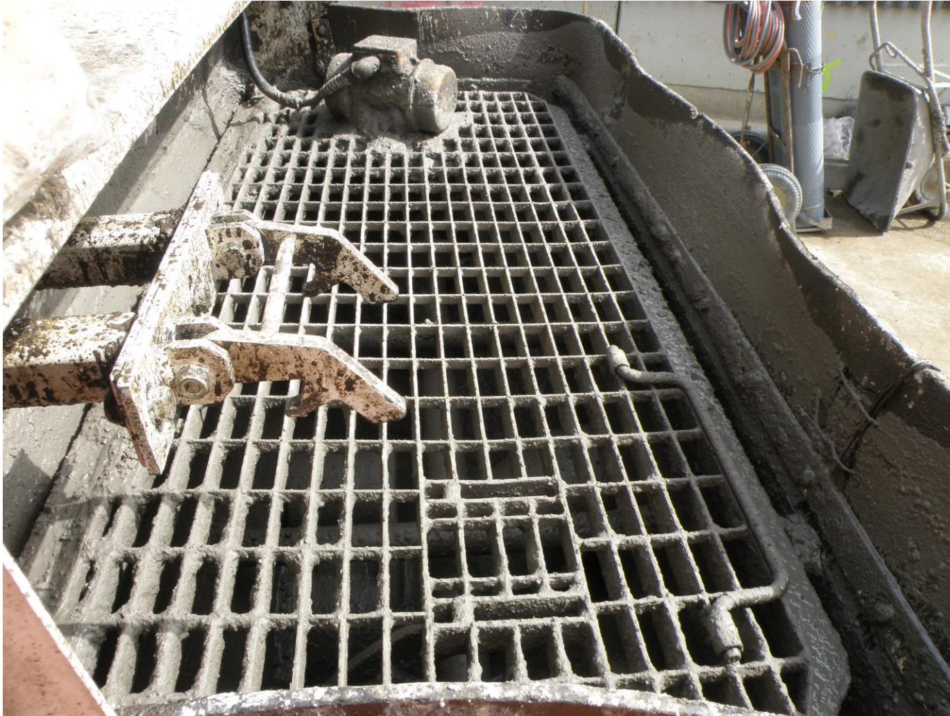
Pompa per il calcestruzzo
