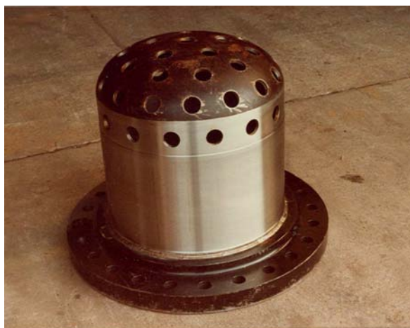
Figura 23.4 - Particolare di un espansore per scarico vapore.
