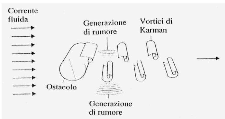
Figura 21.3 - Generazione dei vortici nell'interazione di un corpo tozzo con una corrente.
