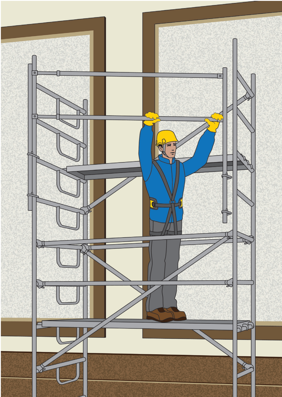
Figura 4 - Trabattello con montaggio dal basso
